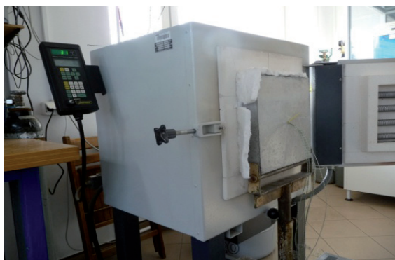
Rys. 2. Betonowa płyta (P2) umieszczona w piecu
